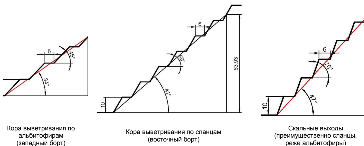
Рисунок 1 – Расчетные эпюры устойчивых бортов карьер для условий однородных вмещающих пород
